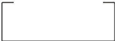
STEEL STUD STUD 92 x .55 x 3000mm STUD 92 x .55 x 3600mm STUD 92 x .55 x 4200mm
